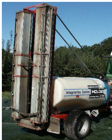
Figur 13. Spruta 8 – Holder fläktspruta.
