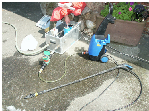
Figur 3. Högtryckstvätten som använts vid rengöringen av sprutor och traktorer.
