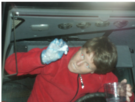
Figur 5. Provtagning på insidan av en traktorframruta genom att en yta gnuggas med bomullstrasa indränkt i metanol.
