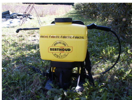
Figur 2. Ryggssprutan som användes för applicering av rengöringsmedel och för simulering av regn.
