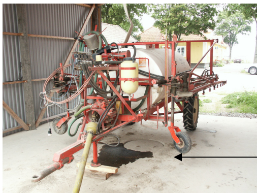
Bild 3. Under betongplattan finns uppsamlingbehållaren som skyddas med ett lock (pilen) Foto Eskil Nilsson
