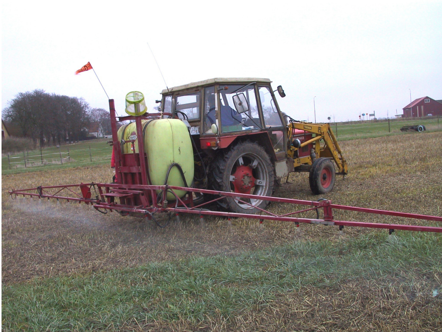
Figur 3. Lantbruksspruta Hardi med 1000 liters tank och 12 m ramp.
