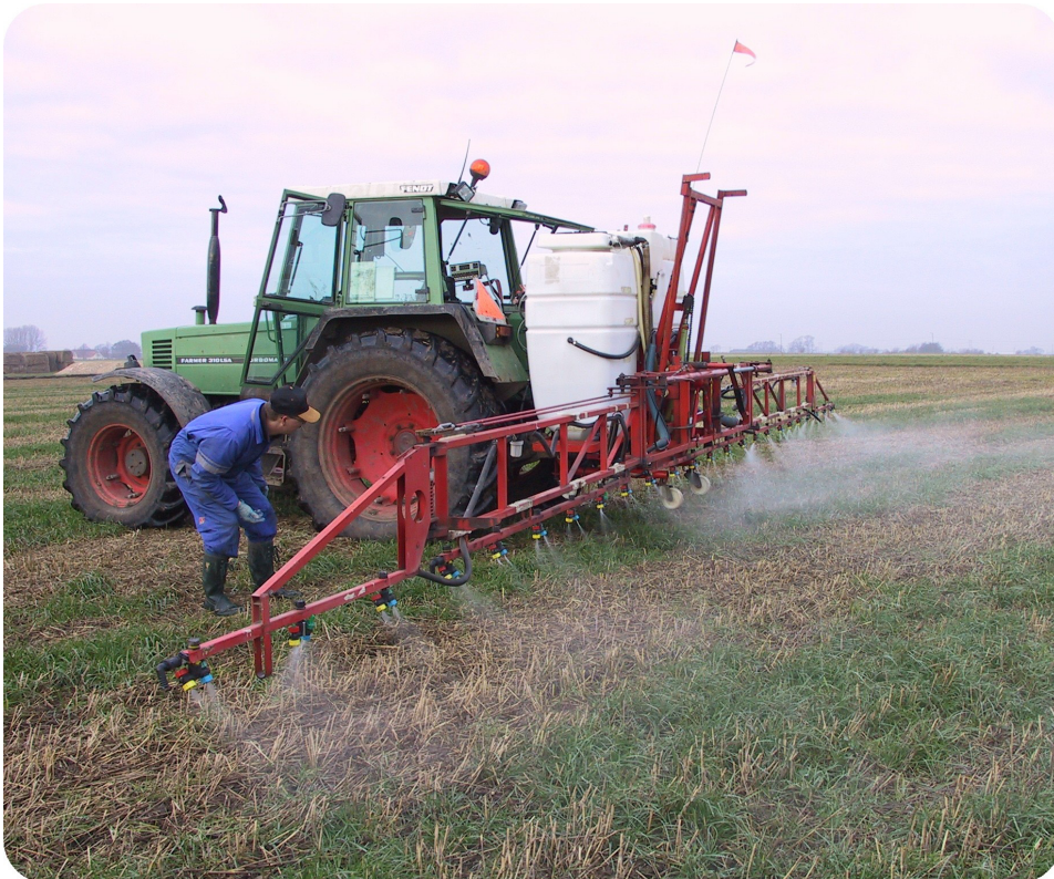
Figur 4. Holdersprutan - bomspruta med 12 m ramp och 1000 liters tank.
