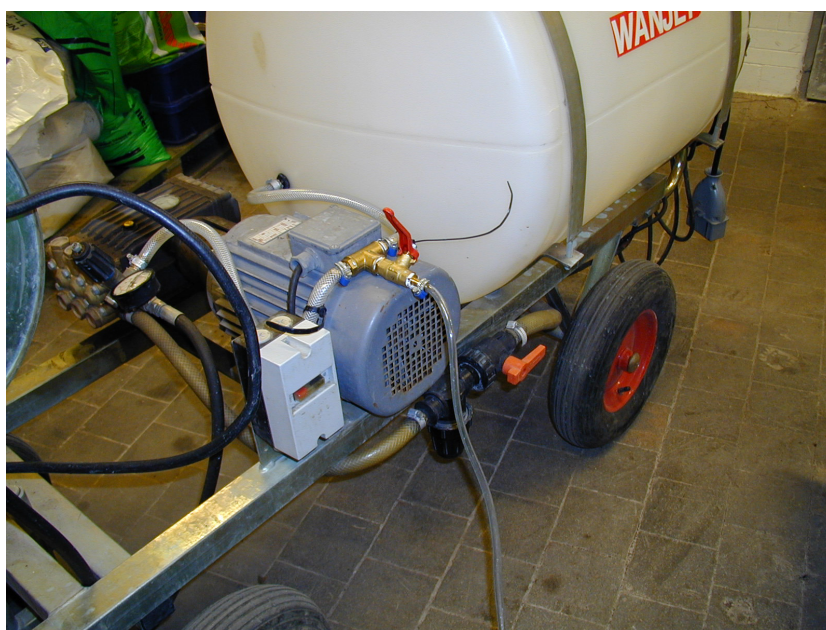
Figur 5. Pump och den extra tappslangen på Wanjetsprutan.
