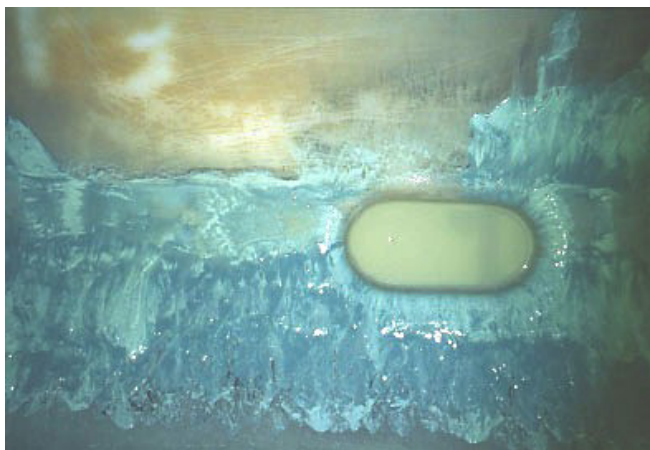
Figur 8. Rester på botten av tanken på sprutan Wanjet HP-300 med originalomrörning efter omrörningsstudie med kopparoxykloridlösning.
