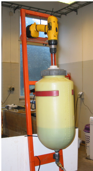
Figur 10. Tanken vi använde under omrörningsförsöken med Micronsprutan. Bormaskinen på toppen fungerar som motor för den mekaniska omrörare som går ned i tanken.
