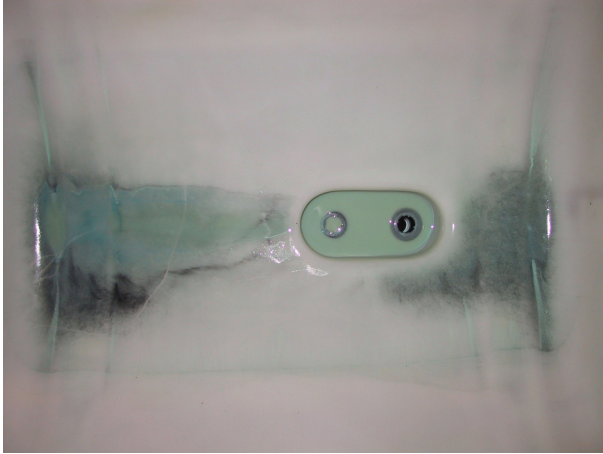
Figur 9. Rester på botten av tanken på sprutan Wanjet HP-300 med mekanisk omrörare efter omrörningsstudie med kopparoxykloridlösning
