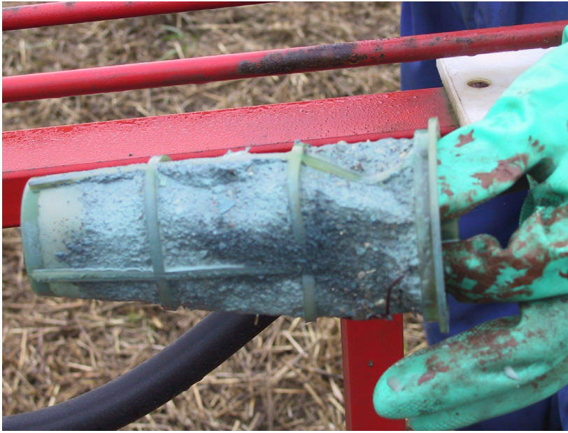
Figur 13. Filter från Holder lantbruksspruta igensatt av kopparoxyklorid.
