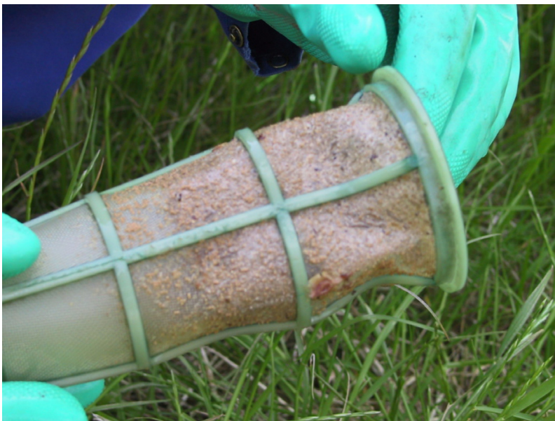
Figur 17. Filter till Holder lantbruksspruta igensatt av PreFeRal.
