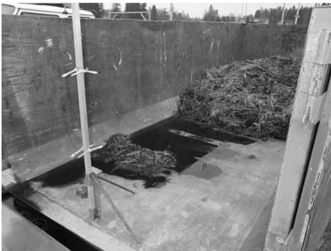
Bild 2. Container för pilotförsök, iordningställd för att efterlikna en sluttande lagringsplatta för fastgödsel med tre väggar.
