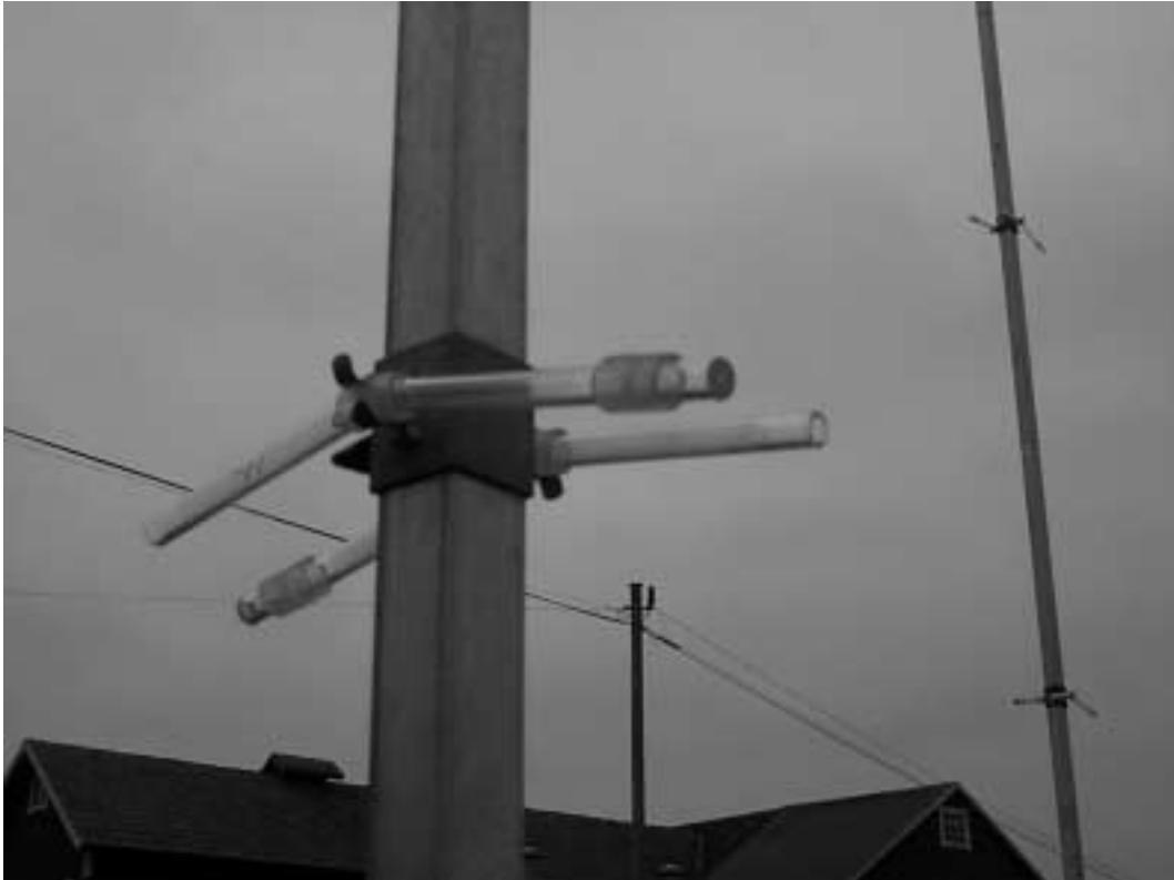
Bild 3. Passiva fluxprovtagare som består av två oxalsyrebestrukna glasrör sammanfogade med en bit silikon slang.
