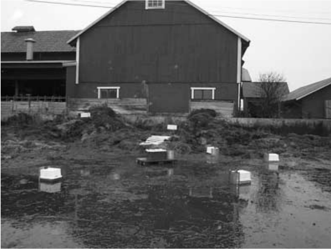
Bild 5. Provtagningskammare uppställda på den torrare zonen som utgörs av färskare gödsel på den bakre delen av plattan, på den kletigare zonen som kan beskrivas som en gränshfas i framkant av den fasta gödseln samt på zonen med flytande gödselvätska som består av urin, regnvatten och mycket lös gödsel.
