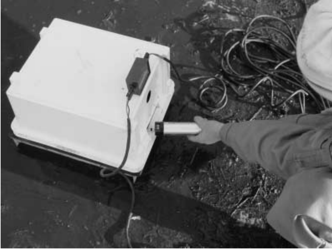
Bild 7. Direkt konzentrationmätning i provtagningskammaren med reagensrör och luftpump av fabrikat Kitagawa.
