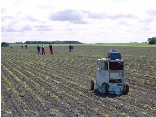
Figur 2. En mindre försöksmaskin användes vid provning av plantigenkänning (här utan rensningsverktyg).
