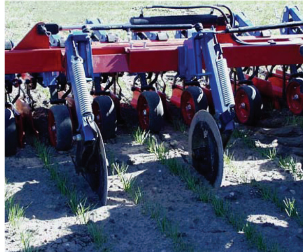
Figur 1. Olika system för att styra redskapet i sidled: Hydraulisk sidoförskjutning av redskapets bäraxel (t. v.) och styrskivor som kan styras med hjälp av hydraul- eller elcylinder (t. h.) (ECO-DAN, www).
