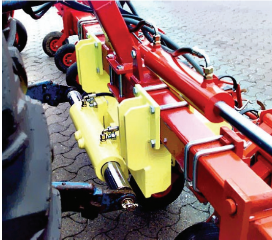
Figur 1. Olika system för att styra redskapet i sidled: Hydraulisk sidoförskjutning av redskapets bäraxel (t. v.) och styrskivor som kan styras med hjälp av hydraul- eller elcylinder (t. h.) (ECO-DAN, www).
