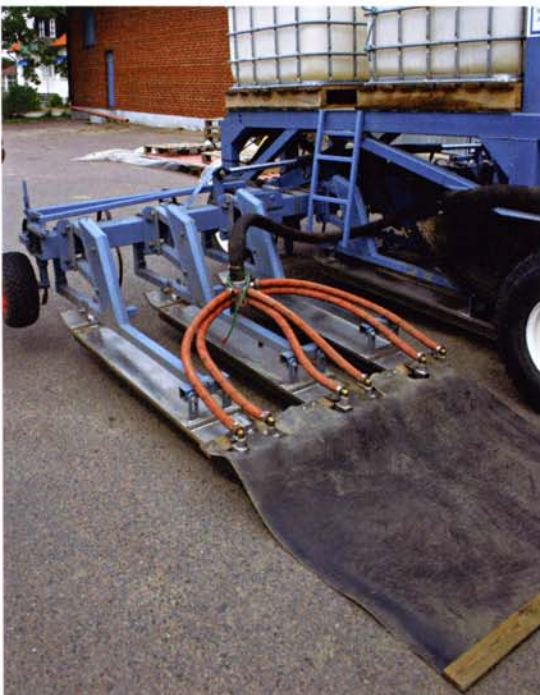
Bilden till vänster: Släpduken efter ångningsaggregaten göra att värmen hålls kvar i jorden och bättre effekt uppnås. Bilden ovan: Lars Larsson på Stockholmsgården visar motorn som driver ångningsmaskinen. Foto: Christina Säll.
