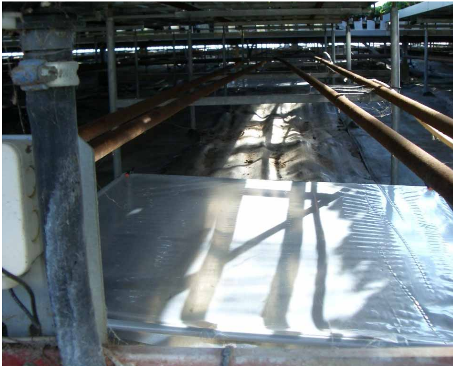
Figur 1. Mätpunkter, dvs 1 x 1 m ramar med uppspänd plastfolie utplacerade under borden.
