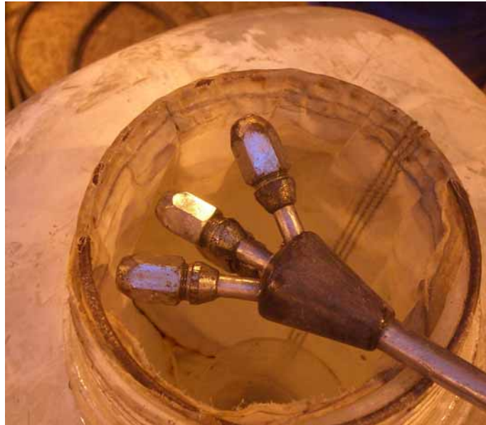
Figur 3. Sprutmunstycke av typen Rosmunstycke. Fyra virvelkammarspridare av märket Vanjet.
