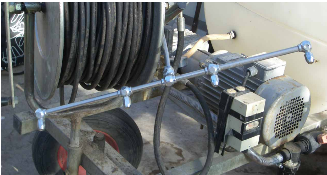
Figur 7. Sprutrampen som användes vid andra mätningen.
