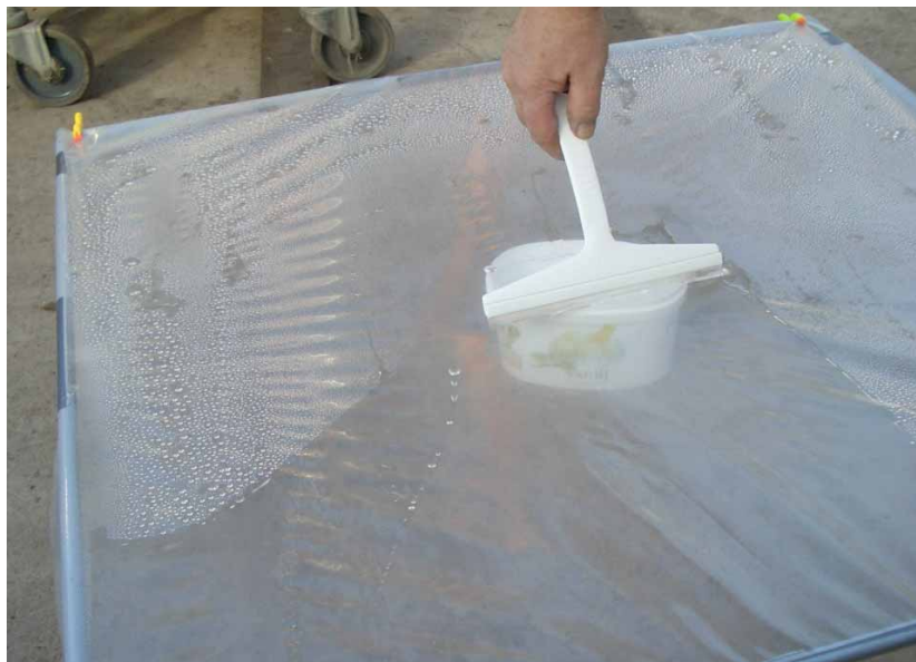
Figur 5. Plastfolien är sprutad med rent vatten. Tvättvattnet skrapas in mot mitten och rinner genom ett hål ner i en burk.
