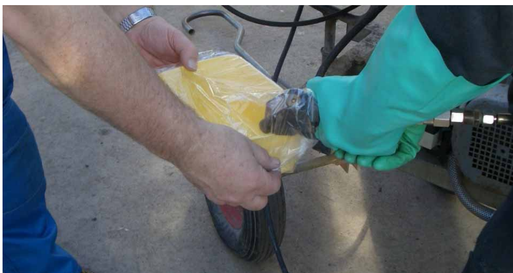
Figur 8. Ett prov på den koncentrerade sprutvätskan togs före sprutning.
