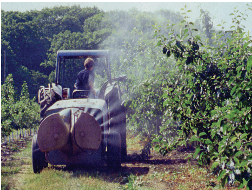
Figur 14. På Schaumannsprutan är det möjligt att vrida luftutloppen, men det saknas var för sig justerbara övre och undre begränsningsplåtar. Spridarna kan stängas av, men riktningen kan inte ändras i förhållande till luftutloppet.
