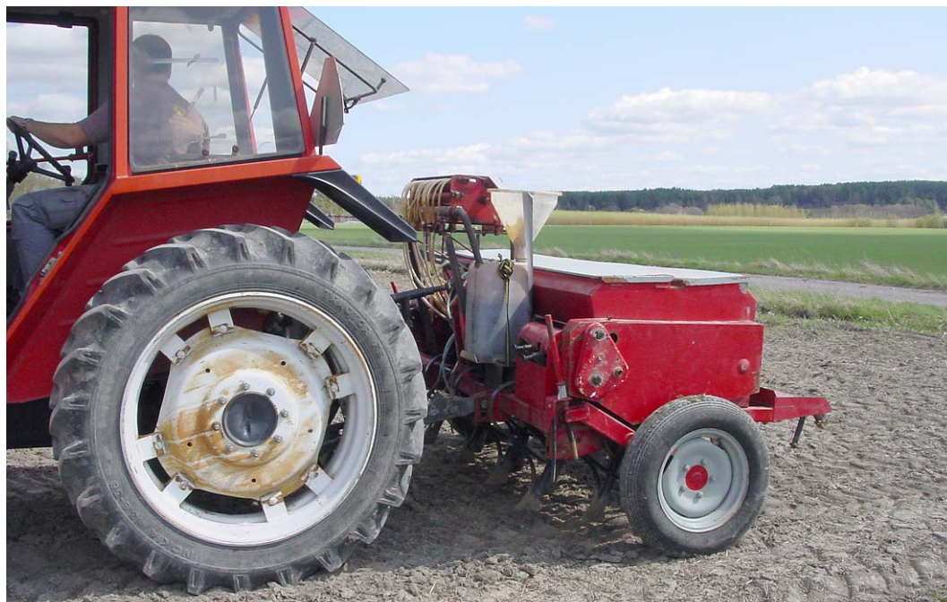
Figur 3. I samtliga försöksled användes en modifierad kombisåmaskin av fabrikat Juko med arbetsbredden två meter för gödsling och sådd.
