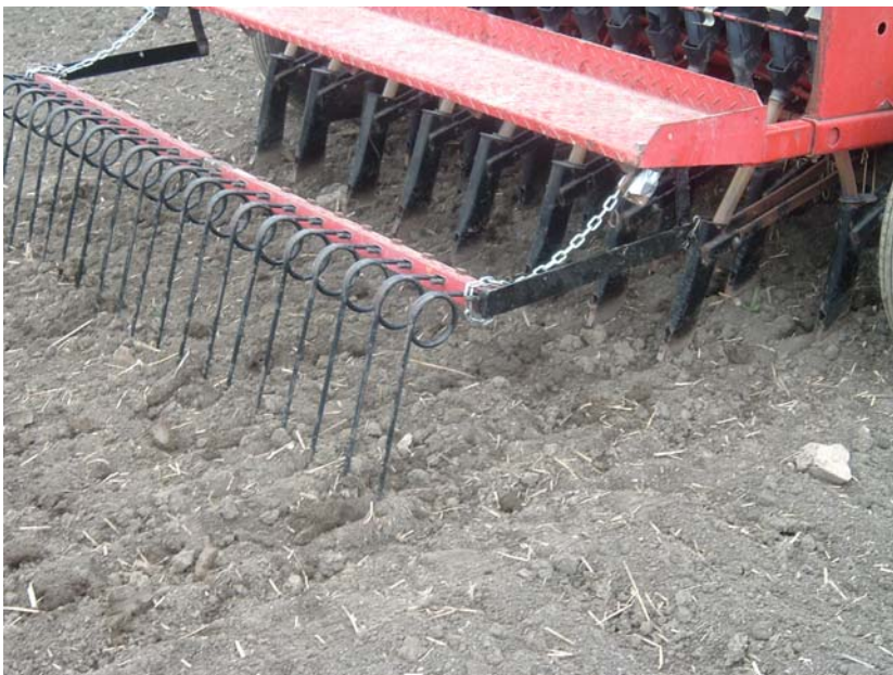
Figur 7. Till 2004 års fältförsök hade kombisåmaskinen försetts med efterharv. Foto: Claes Jonsson.
