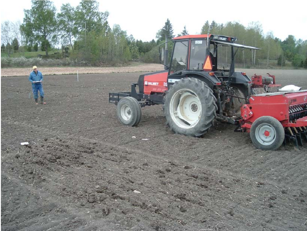
Figur 6. Framför kombisåmaskinen begagnades från och med 2004 års försök en traktor med mycket stor spårvidd vilket medförde att spårbildningen inom parcellerna minimerades. Foto: Claes Jonsson.
