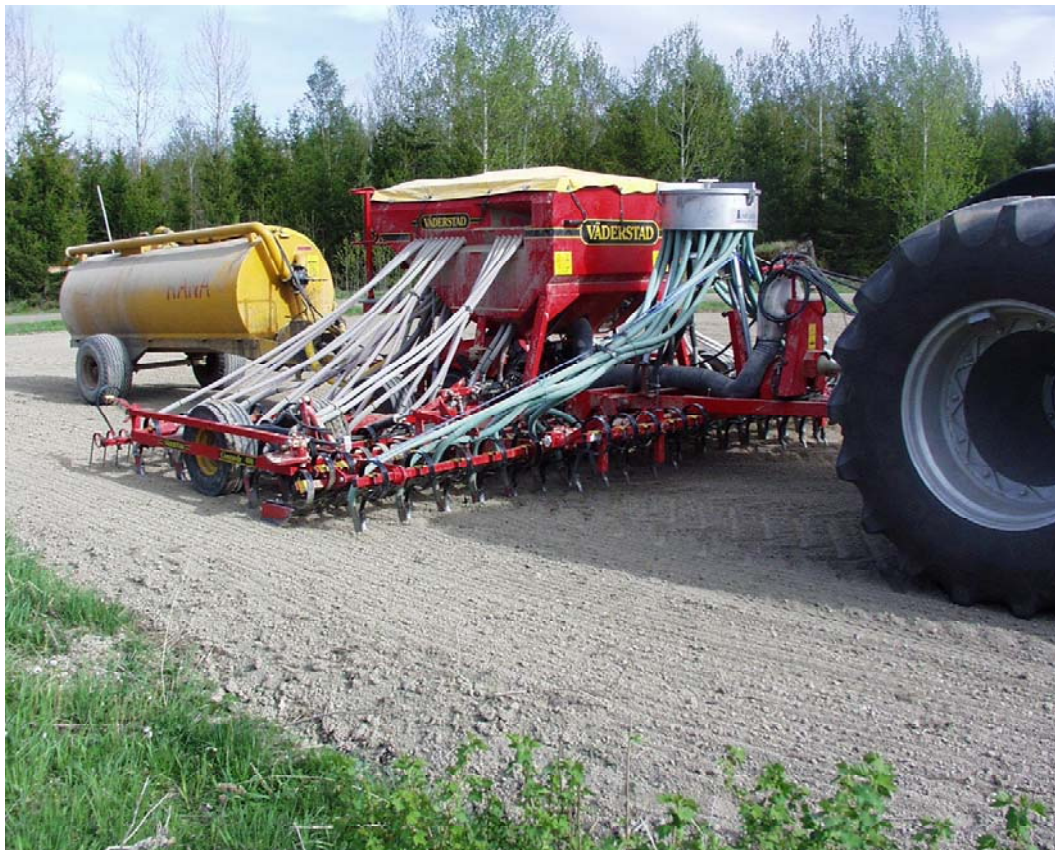
Figur 2. Harvsåmaskinen Väderstad Concorde utrustad för samtidig gödselmyllning och sådd, upp till 5m 3 vinass per fyllning. Foto: Kurt Hansson
