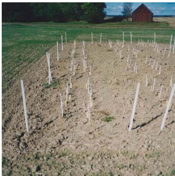
Figur 3. Principbild för placering av inkubationsburkar på fältytan, med burkarnas botten på 20 cm djup och med jordtäckning till 3 cm ovanför burklocket. Ventilationsrören stack upp ca 30 cm över markytan.
