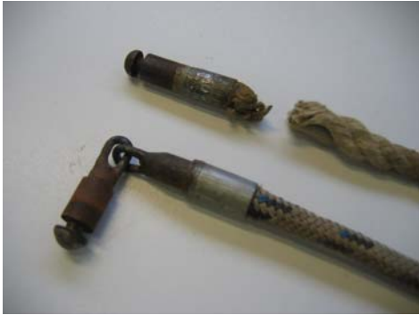
Bild 7 & 8. Vidareutveckling av repets infästning i låsanordning. Fällbygel som kan låsa upp flera båsplatser på en gång. Denna monteras på bekväm arbetshöjd på lämplig stolpe i anslutning till båsplatserna.
