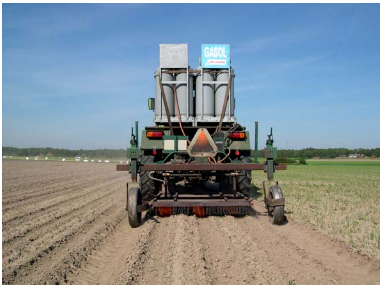
Figur 7. Flamning av ogräs strax före grödans uppkomst i ekologiskt odlade morötter (foto: David Hansson).
