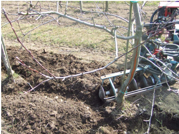
Figur 12. Ogräsbekämpning med Aspedo-Figli (driven roterande tallriksharv) (foto: Sven Axel Svensson).
