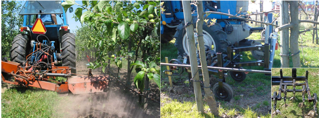
Figur 1. Ogräsbekämpning med jordfräsen Rinieri (vänster) och med radhacka (kultivator) med gåsfotsskär (höger) (foto: David Hansson).
