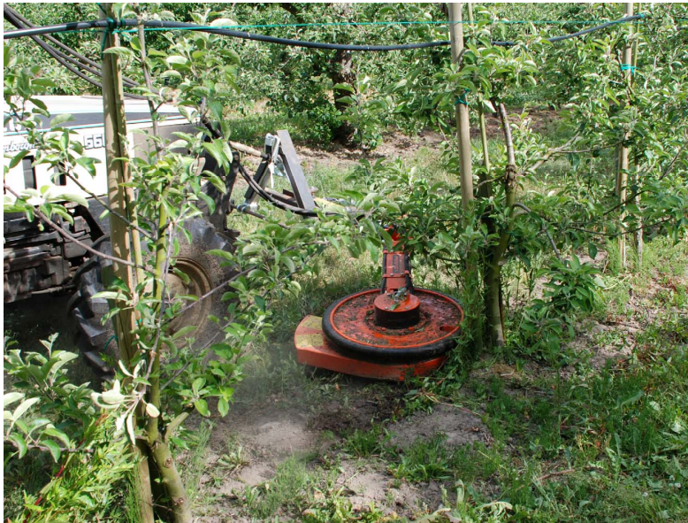
Figur 18. Klippning av ogräs inne i trädraden med rotorklipparen Soloswing (foto: David Hansson).
