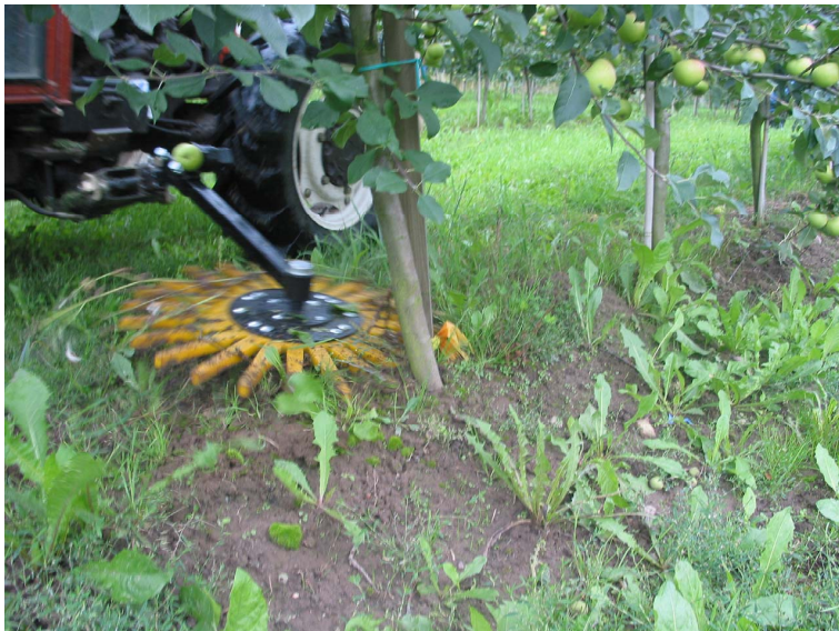
Figur 19. Ogräsbekämpning med fingerhjul (Kress) (foto: Sven Axel Svensson).
