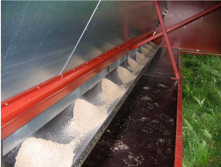
Figur 9. Kalibrering av mängd utmatat foder per tidsenhet för varje utsläppshål.
