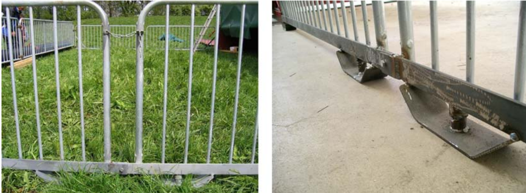
Figur 7. Grindar av typen QR universalräcke kompletterade med släpskor för att lättare kunna dras framåt.
