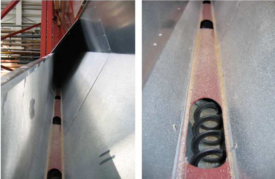
Figur 5. Foderfickan samt detalj av utloppen från foderfickan.
