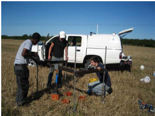
Figur 1. Provtagning av jord i kolonn med hjälp av hydraulisk press (vänsterbild) och preparerad kolonn före regnsimulering (högerbild).
