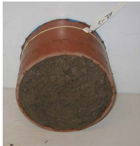
Figur 1. Provtagning av jord i kolonn med hjälp av hydraulisk press (vänsterbild) och preparerad kolonn före regnsimulering (högerbild).
