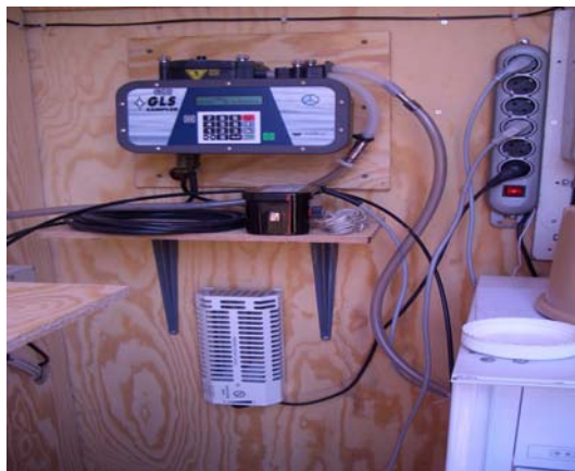
Foto 1. Utrustning för tidsstyrd vattenprovtagning och för kylförvaring av flödesproportionellt tagna vattenprov från Skilleby-dammen.
