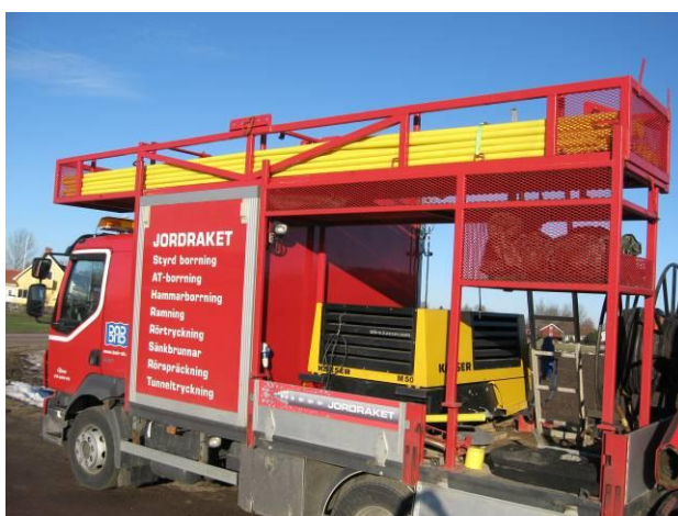
Figur 14. En så kallad jordrak som används vid enklare rördrivning genom väg- och järnvägsbankar.
