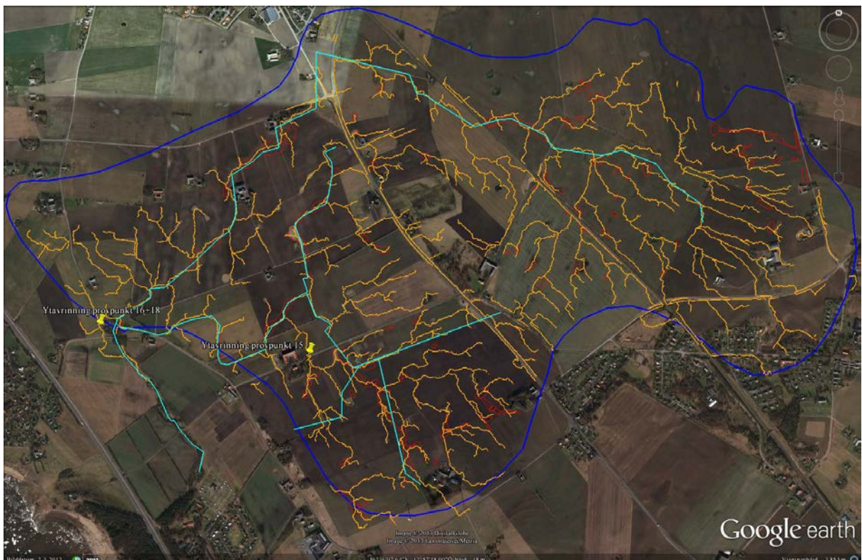
Figur 5. Typområde N33 med erosionsområden dokumenterade genom fältvandring (röda polygoner) samt USPED modellerade erosionsområden där materialtransport överstiger 1000 kg eroderat material per cell. Den ljusblå linjen visar den nu helt kulverterade bäcken som den såg ut år 1919.
