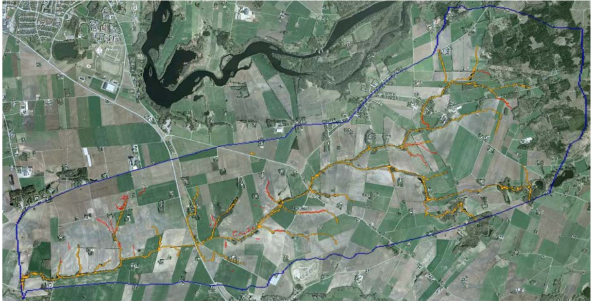
Figur 4. Långevadsbäcken med erosionsområden dokumenterade genom fältvandring och flygbildsanalys (röda polygoner) samt USPED modellerade erosionsområden där materialtransporten överstiger 1000 kg eroderat material per cell.
