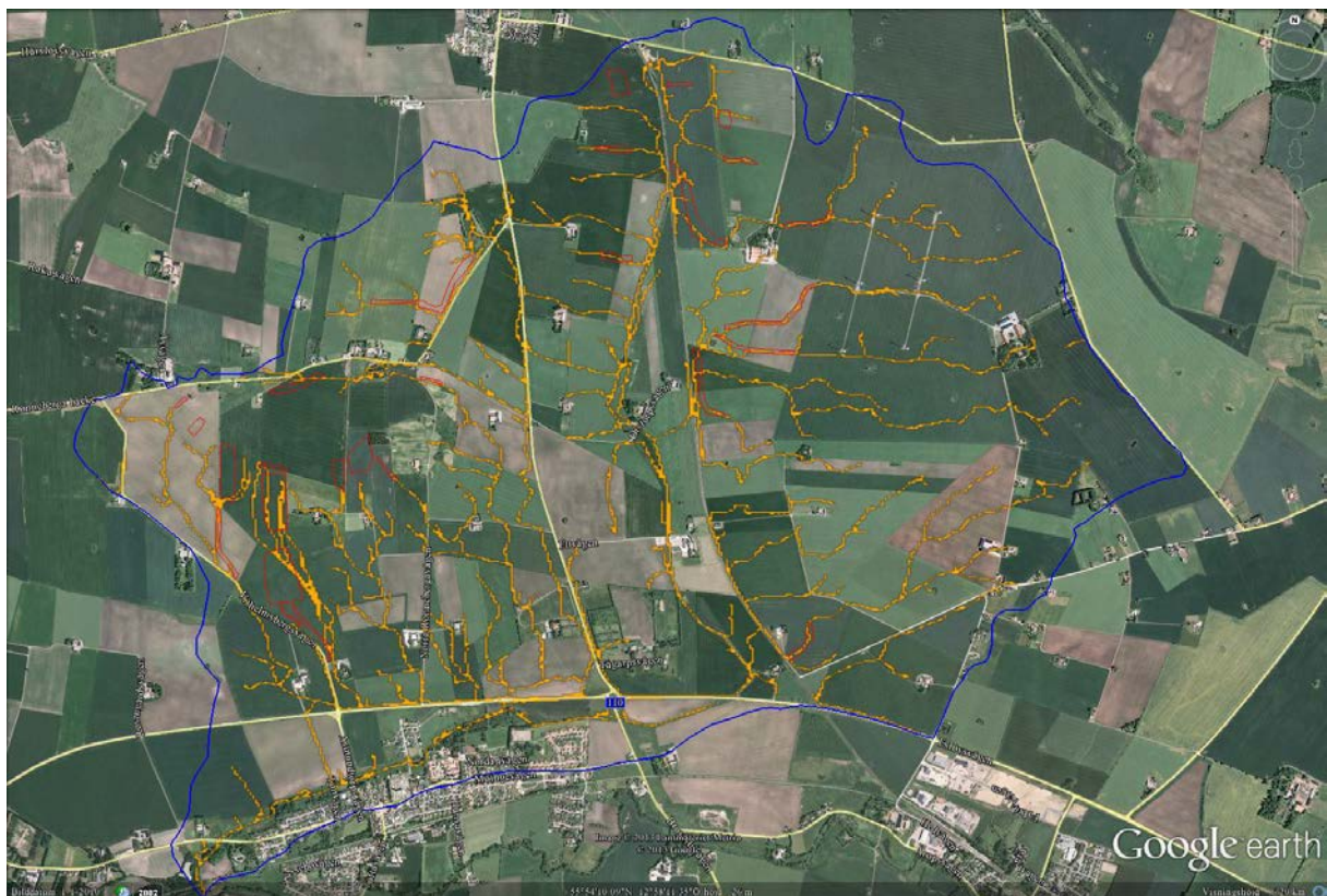
Figur 1. Örstorpsbäcken med erosionsområden dokumenterade genom fältvandring (röda polygoner) samt USPED modellerade erosionsområden där materialtransport överstiger 100 kg eroderat material per cell (orange linjer).
