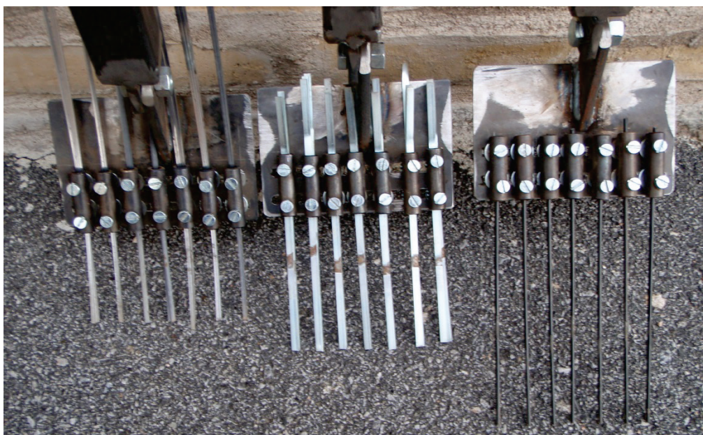
Bild 3:1. Tre harvaggregat med olika "harvpinnar" som undersöktes vid selektiv harvning i raden. De harvpinnar/borstknippen som undersöktes var: smala platta (tv), breda platta fjäderblad (i mitten) samt runda fjäderblad (th). Foto David Hansson.
