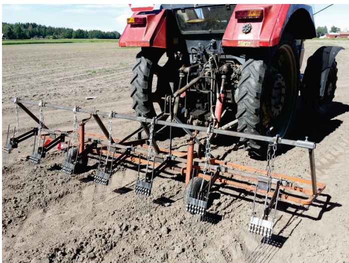
Figur 6. Utrustning för selektivharvning i morotsraden med ett "harvaggregat" per morotsrad.
