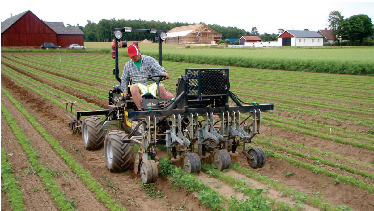
Figur 5. Utrustning för selektivharvning i morotsraden. Radhackan utrustades med ett ”harvaggregat” per morotsrad, d.v.s. tre harvaggregat per bädd.
