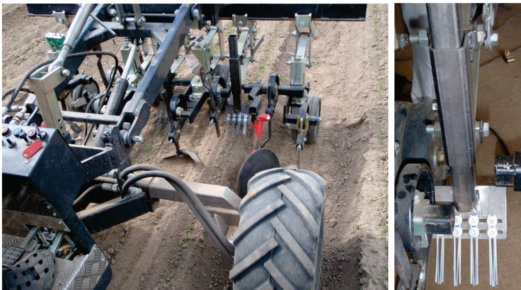
Figur 2:8. Ogräsharvning i raden med redskapsbäraren Mactrac. Till höger, närbild på harven bestående av bladstålborstar. Foto David Hansson.
