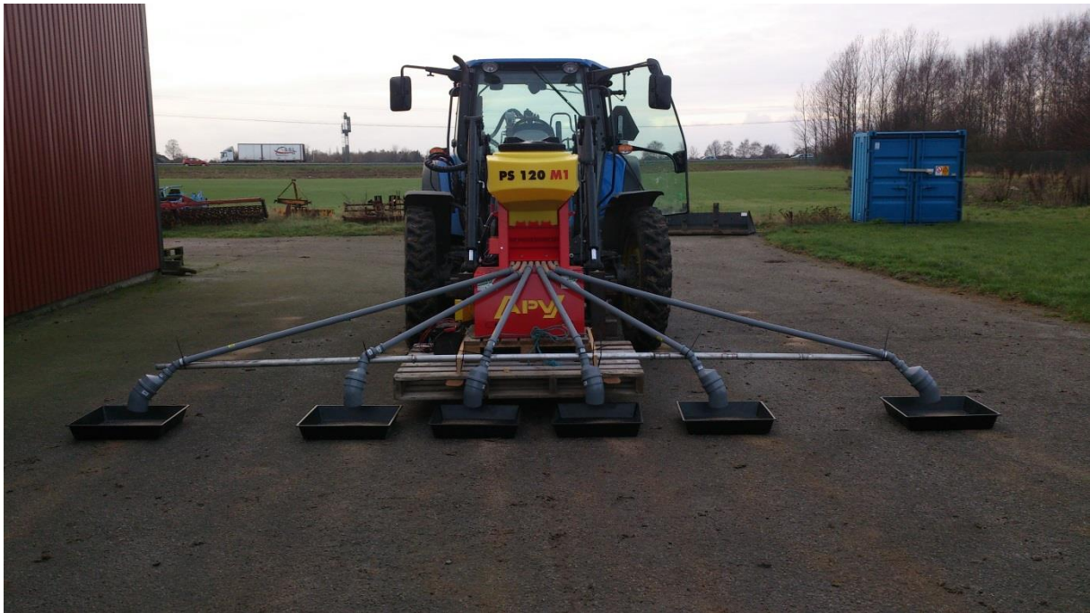
Bild 4. APV spridartest frontmonterad. Spridaren monterad på ett demonstrationsstativ som i sin tur var fastbultad i en lastpall för att bäras i frontlastaren eller på pallgafflar i trepunktslyften. I detta fall var 6 ramprör monterade rader för spridningstestet. I tillhandahåller inte maskintillverkarna spridarramper till frösåmaskinerna.
