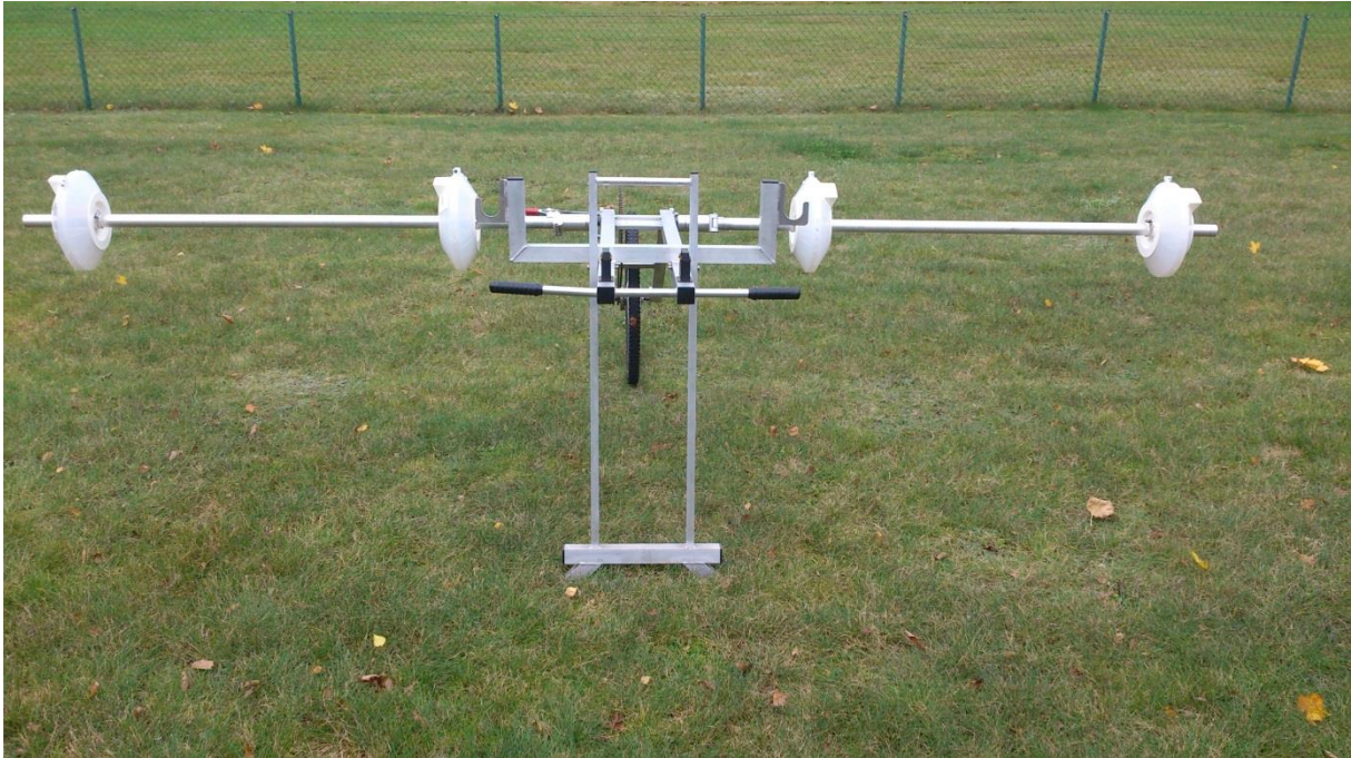
Bild 5. Koppert Spridare. Koppert spridare sedd bakifrån. Fyra utmatningsorgan är för närvarande monterade. Ytterligare en axel-längd kan monteras i vardera änden, vilket medger fler utmatningsorgan. Totalt sex utmatningsorgan medföljer.
