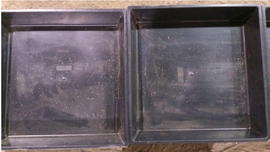
Bild 9. Uppsamlingsbackar. Två uppsamlingsbackar med material efter spridning. Backarnas storlek är 0,50 * 0,50 m.
