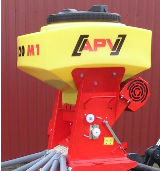
Bild 3. APV Spridare. Spridaren består av en behållare med en elektrisk styrd utmatningsvals. En fläkt skapar ett luftflöde som för materialet till spridarorganet över raden. Materialet är skyddat för vindpåverkan hela vägen från behållaren till dess det når plantan genom ramprören och utsläppsorganen, en för varje rad.
