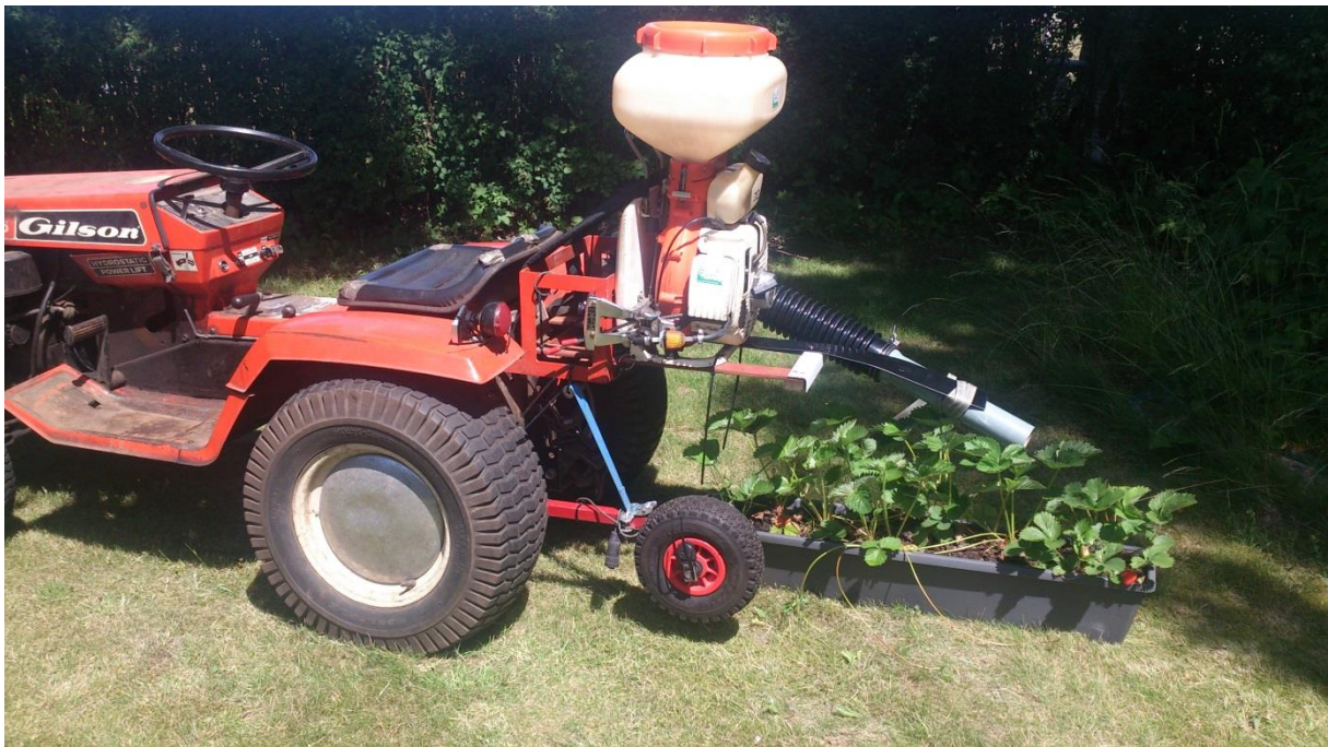
Bild 1. En "rovkvalsterblåsare" som är en luftassisterad ryggspruta placerad på en trädgårdstraktor för spridning i rader.
