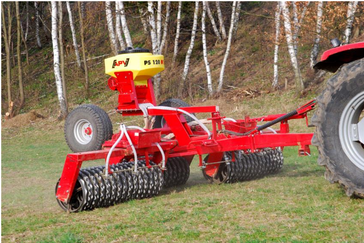
Bild 2. Pneumatisk fallspridare APV. Spridaren är försedd med elektriskt kontrollerad utmatningsvals och elektriskt kontrollerad fläkt för transport av frö, gödsel, etc från behållare till spridarorgan. Vanligen monteras den på redskap som kultivatorer, vältar, såmaskiner, mm. Foto APV Österrike.
