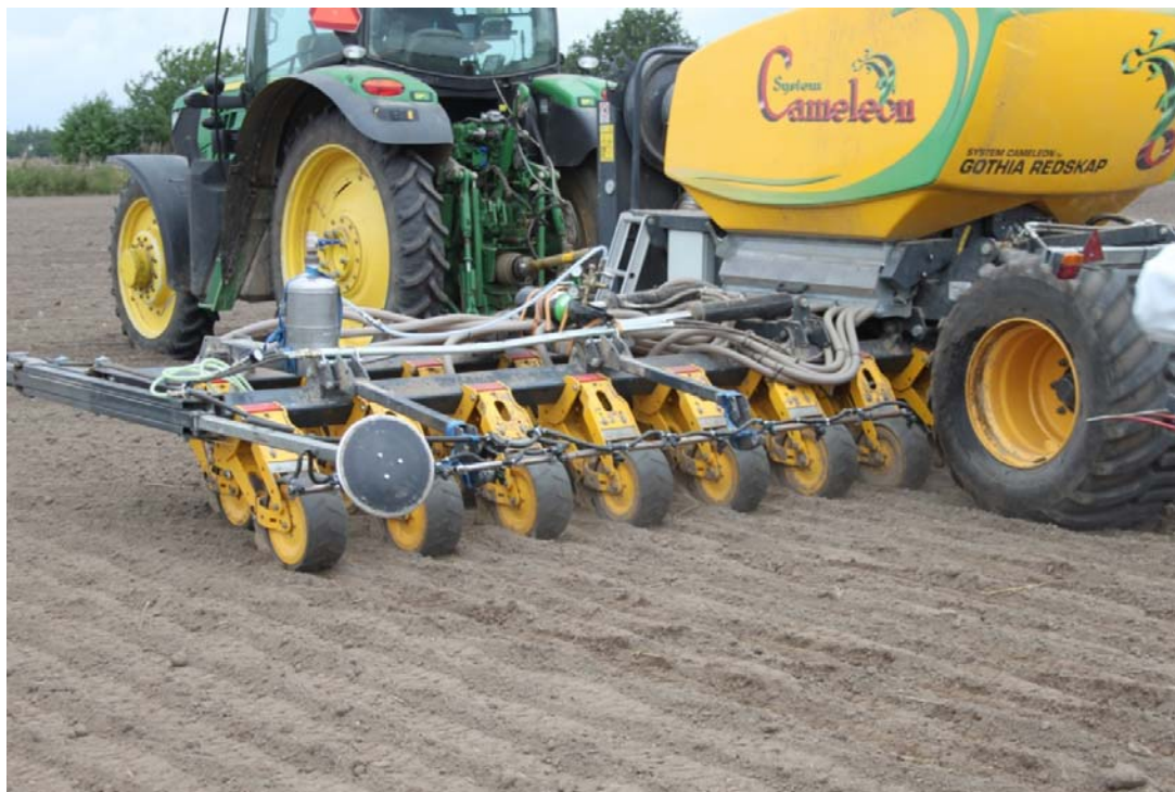
Figur 7. Bilden visar sprutrampens placering på en System Cameleon maskin. Här utfördes sådd och sprutning av höstraps samtidigt. Ett tryckluftsreglerat sprutsystem ersatte den konventionella sprutan i frontlyften och sprutbommen monterades bakom såbillsorganen. Systemet kördes endast på ena sektionen i försöken mot hela arbetsbredden då den ombyggda JT-bandsprutan användes.
