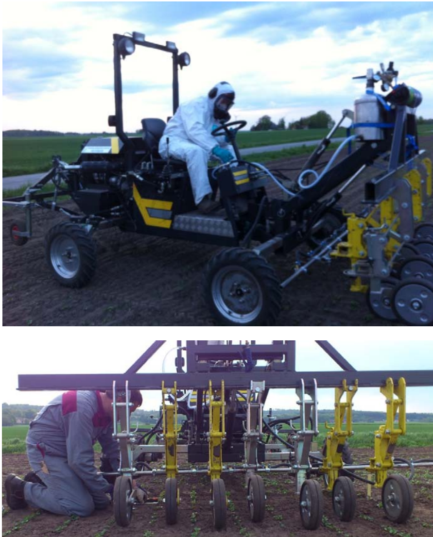
Figur 3. Övre bilden visar redskapsbäraren med sprutrampen monterad på hackorganen mellan redskapsbäraren och hackorganen. Radföljning görs manuellt. Nedre bilden visar redskapsbäraren med sprutrampen frontmonterad på organen till radhackorna i samband med justering av appliceringsbredden.
