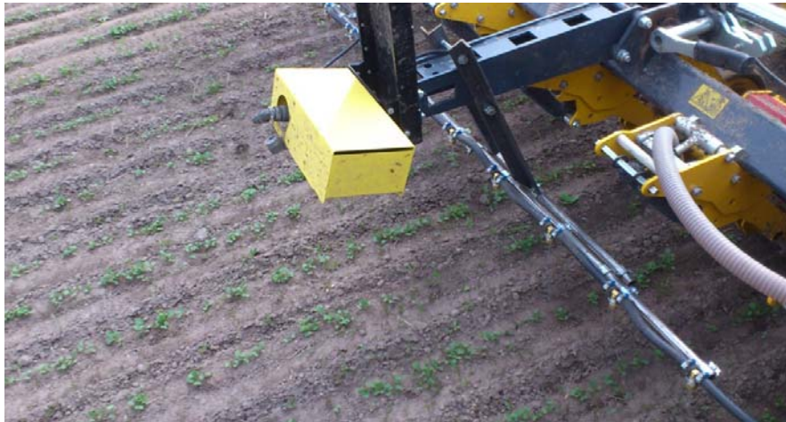
Figur 4. För radföljningen användes kamerateknik, vilken var monterad framför sprutrampens högra sektionssdel på den System Cameleon som användes i försöken.
