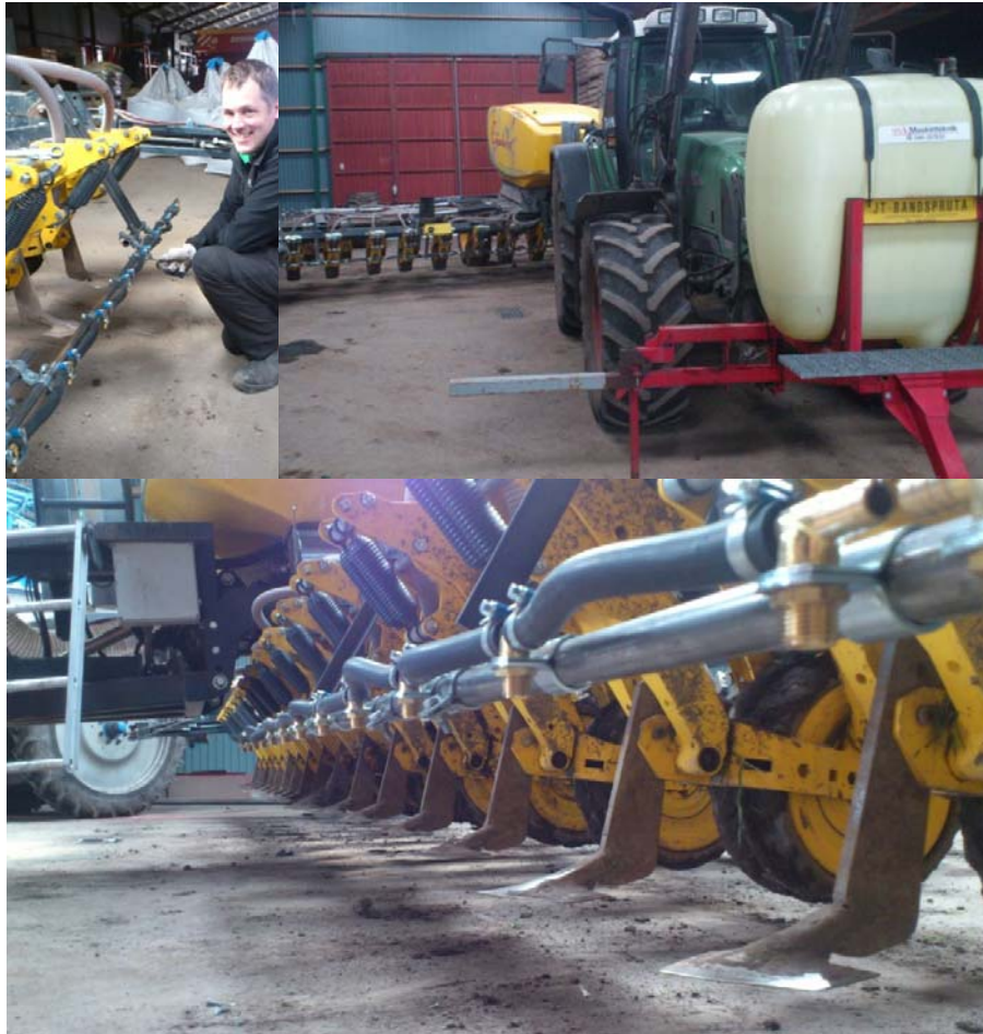
Figur 2. Bilden överst till vänster visar montering av sprutbommen med munstyckshållare framför första raden av hackorgan på Cameleon. Bilden överst till höger visar spruttanken som bärs i frontlyften, pumpen har PTO drift. Manövreringen av sprutan vid försökssprutningen utfördes från System Cameleons plattform vid draget. Sprutrampen monterad framför så-hackorganen. Vid radsprutningen demonterades hackorna.
